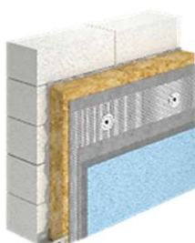
ШТУКАТУРНЫЙ ФАСАД (СФТК)
